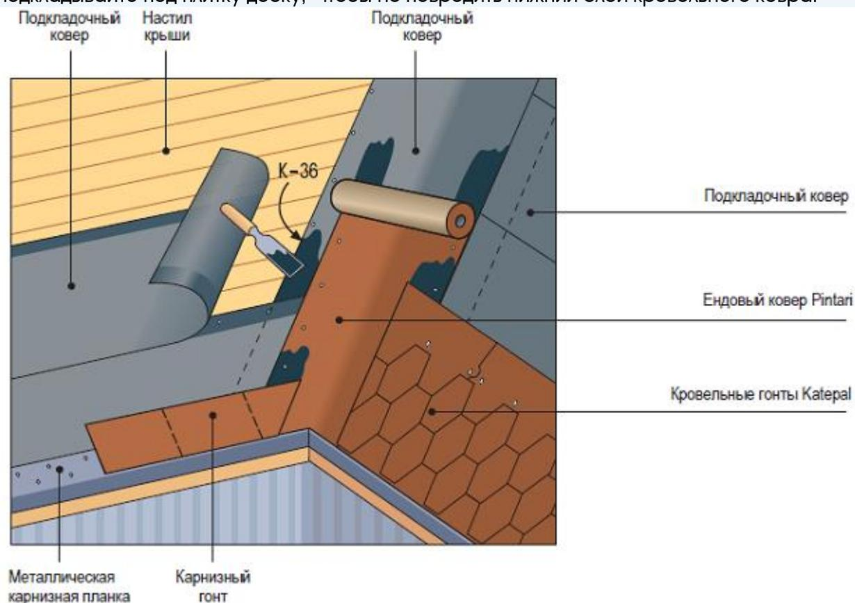
12. В случае монтажа фронтовой планки поверх рядовых гонтов рейки со скошенными углами, образующие бортик кровли, следует закрепить к обрешетке до монтажа подкладочного покрытия. Ковер нужно загнуть по краю обрешетки так, чтобы он выходил наружу на 1-1,5 см из-под обрешетки. Рядовая черепица должна быть смонтированы так, чтобы края гонтов следовали по кромке, не вылезая за ее край. Края гонтов должны быть приклеены к подкладочному ковра клеем KATEPAL K-36 вдоль линии отреза на ширину не
