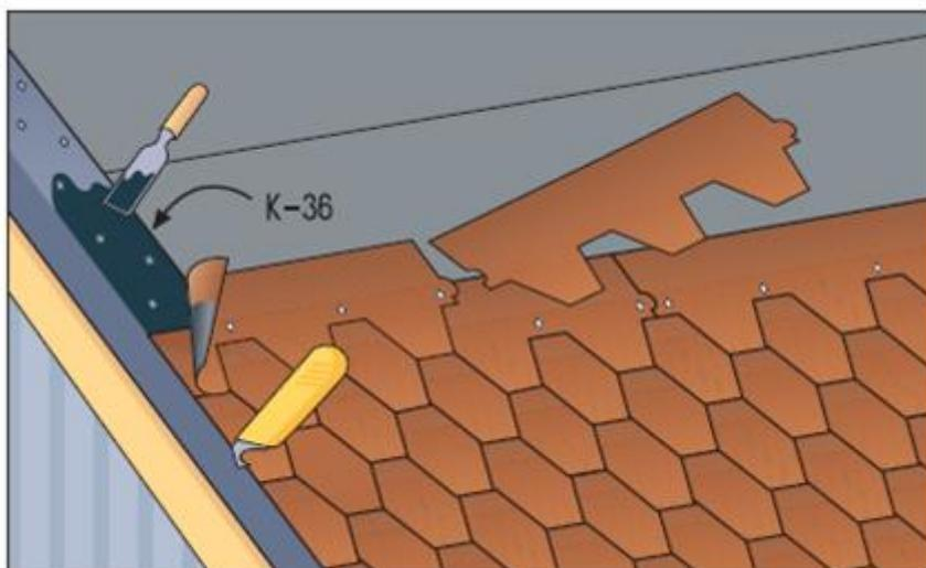
10. Продолжайте монтаж черепицы ряд за рядом, время от времени проверяйте параллельность рядов при помощи вспомогательной доски (рис. 8), либо можно использовать разметку маркерной шнуркой по линии швов. При укладке рядов придерживайтесь гребней-пазов соседних плиток. Уровень верхнего края может варьироваться.
