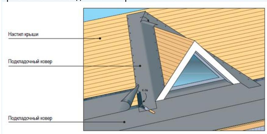
4. Затем подкладочный ковер укладывается по всей поверхности крыши. Инструкция по монтажу находится в рулоне с подкладочным ковром.
