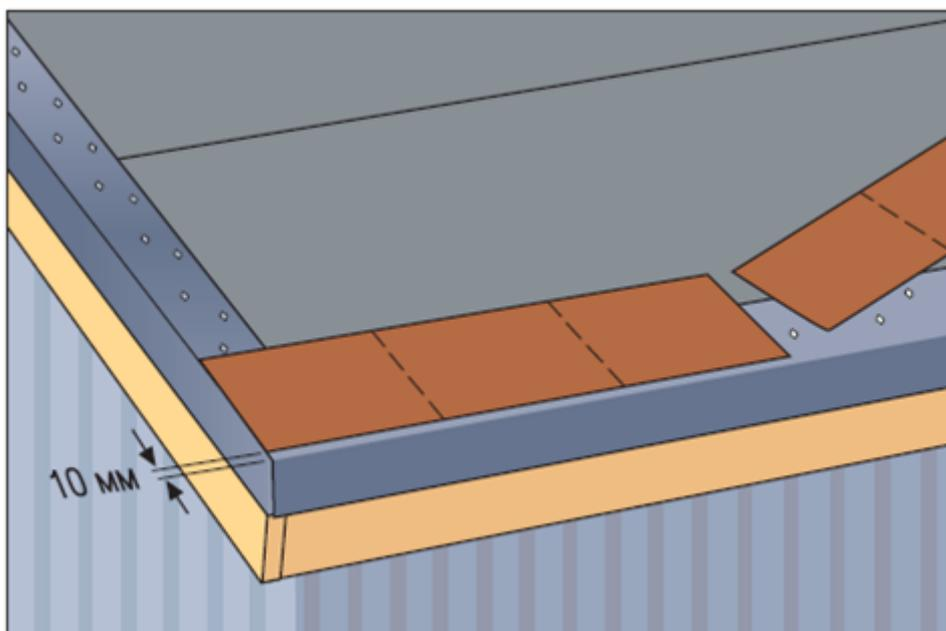
8. Во избежание цветовых отклонений используйте плитки из 4-5 беспорядочно выбранных упаковок! Не укладывайте на одной и той же поверхности кровли плитку, которая была произведена в различное время. Если этого нельзя избежать, цветовое различие должно проверяться непрерывно в процессе укладки. Начните монтаж черепицы с середины карнизного свеса (7b) так, чтобы лепестки плиток закрывали места стыков (линию перфорации) карнизных плиток.
